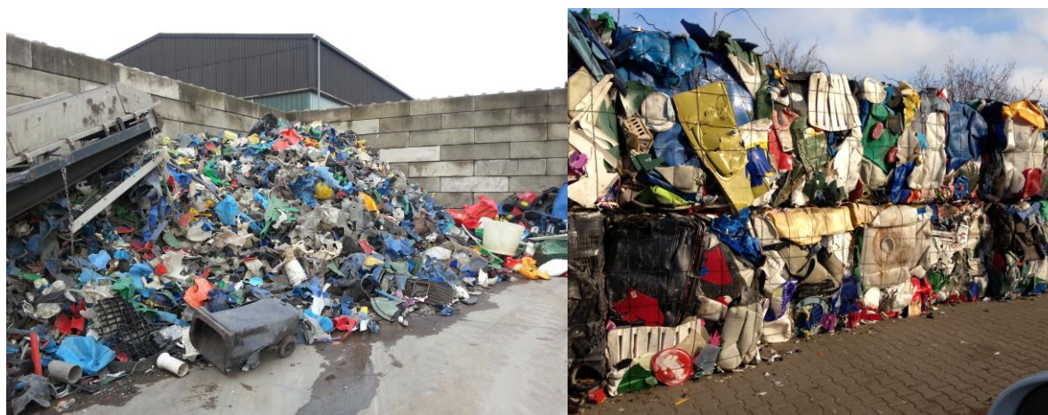
Abbildung 20: Zerleinerte und ballierte Kunststoffhohlkörper am Umschlagplatz
